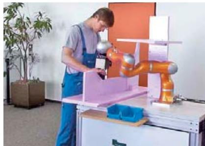
„Heißer Draht“: Ein HARTING Mitarbeiter demonstriert dem Roboterarm einen speziellen Bewegungsablauf an Hand eines Parcours
