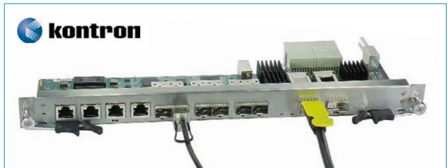
HARTING QSFP+ unterstützt die Anforderungen nach IEEE 802.3ba bis zu 40 Gbps und nach InfiniBand QDR. HARTING liefert für alle Produkte die vollständige Dokumentationen inklusive Signalübertragungseigenschaften und Simulationsmodellen zur technischen Unterstützung.
