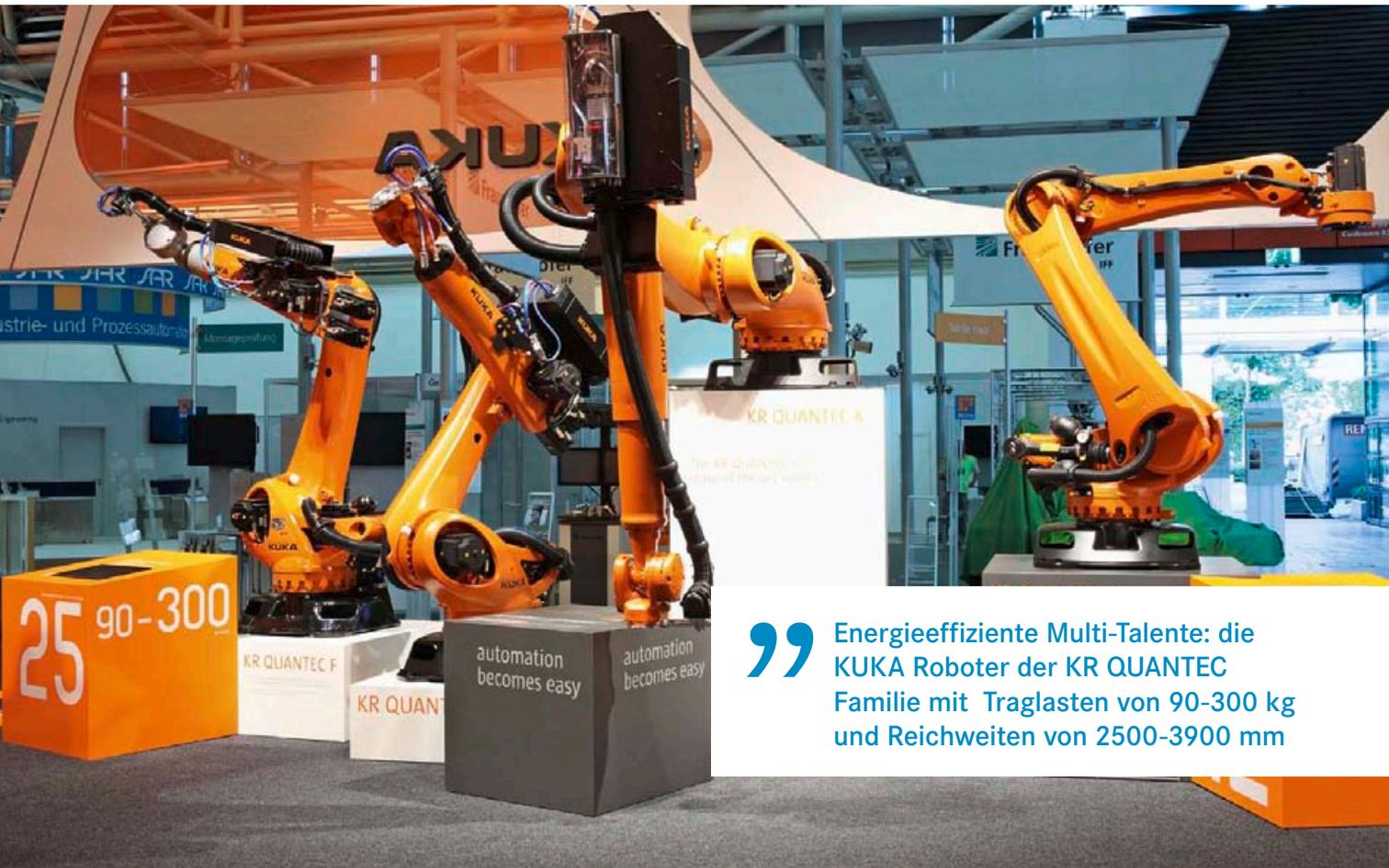
„Energieeffiziente Multi-Talente: die KUKA Roboter der KR QUANTEC Familie mit Traglasten von 90-300 kg und Reichweiten von 2500-3900 mm
