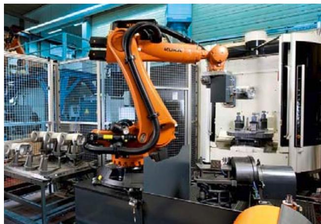
Ein Team, das Mehrwert schafft: KR QUANTEC Roboter beim Be- und Entladen an einer CNC-Werkzeugmaschine
