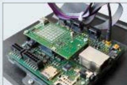
Miniaturisierung bedarf geräteinterner Board-to-Board Schnittstellen und kompakter Einzeladerverdrahtung.
