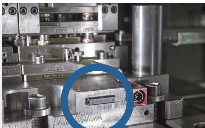
Die Stanzform wurde mit einem RFID-Tag ausgestattet
