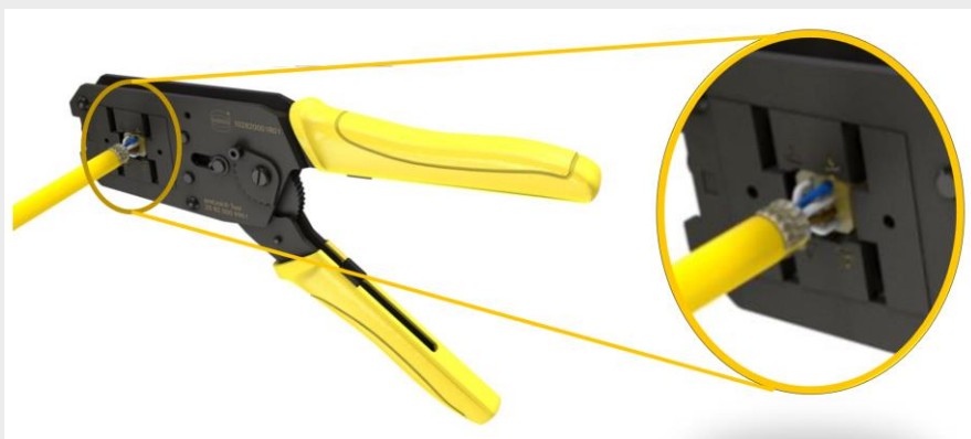
Abbildung 4: Montageschritt 2 – Prozesssichere Konfektion mit dem preLink® Montagewerkzeug
